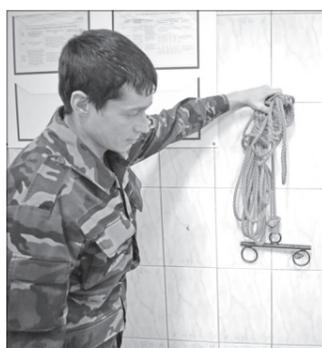
Сотрудник ПГСС демонстрирует приспособление для устранения течи резервуара
