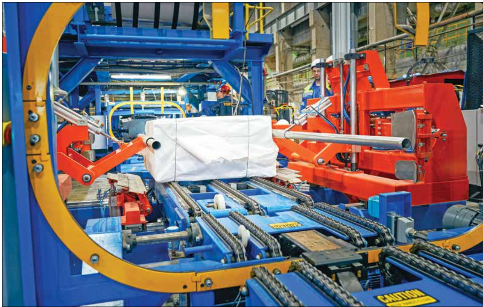
НА ОБНОВЛЯЕМОЙ транспортно-упаковочной линии сушильной машины производства целлюлозы АЦБК
